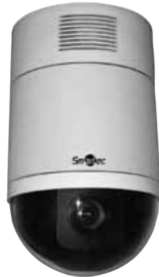
(190° в режиме AutoFlip). PTZ функциями STC-IP3975A можно управлять вручную или запрограммировать до 256 предустановок, 8 последовательностей или 4 тура, которые могут быть активированы вручную по сети с помощью ПО или автоматически по событию. Кроме того, камера позволяет запрограммировать маршрут, который будет повторять все действия оператора в течение заданного промежутка времени, включая работу трансфокатора.
