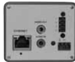
назначить разные реакции. Для подключения охранного датчика IP-камеры имеют тревожный вход, а также TTL-выход для подключения внешнего управляемого устройства. При поступлении сигнала тревоги с детектора или датчика STC-IPM2090A/3090A могут активировать удаленную видеозапись, привести в действие исполнительное устройство, отослать уведомления о тревоге и тревожные последовательности кадров на e-mail или указанный сервер FTP.
