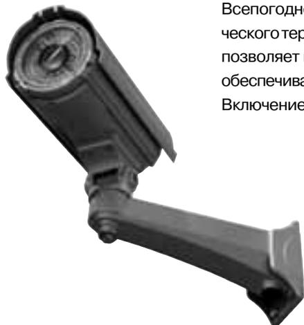
Всепогодное исполнение камеры STC-3650 Xtream обеспечивается за счет металлического термокожуха с уровнем климатической защиты IP66. Встроенный обогреватель позволяет использовать камеру в условиях низких температур (до -40°C). Вентилятор обеспечивает охлаждение камеры при высоких положительных температурах (до +50°C). Включение обогревателя и вентилятора контролируются процессором камеры.
