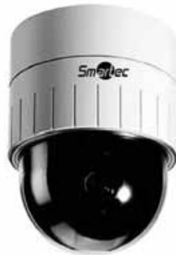
При работе в условиях особо низкой освещенности купольная телекамера может задействовать алгоритм накопления кадров. В этом режиме за счет увеличения времени экспозиции происходит более полное накопление заряда на элементах ПЗС-матрицы.
