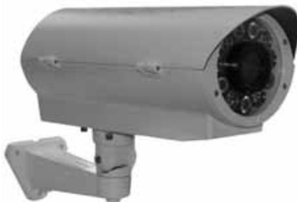
Два встроенных обогревателя подогревают внутреннее пространство кожуха и обеспечивают работу телекамеры в условиях низких температур (до -55°C). Специальный интегрированный в стекло кожуха обогреватель предотвращает запотевание и обмерзание стекла при неблагоприятных погодных условиях.
