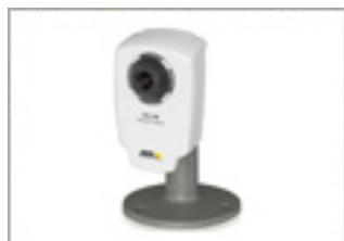
Миниатюрная сетевая камера наблюдения AXIS206 MJPEG формирует кадры с разрешением 640x480 пикс. и передает их по сети со скоростью до 30 к/с. Она имеет web-сервер, меню для настройки качества изображения по IP-сети, допускает одновременное подключение до 10 пользователей, быстро инсталлируется и комплектуется ПО AXIS Camera Explorer. Эта сетевая камера подходит для работы в
