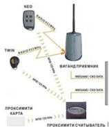
В общем случае при подъезде к воротам или шлагбауму водитель автомобиля нажимает кнопку на имеющемся у него радио брелоке - передатчике, который по радио каналу идентификационный код автомобиля. Стационарный радио приемник принимает этот высокочастотный сигнал и осуществляет его демодуляцию. После этого выделенный идентификационный код транслируется через встроенный в приемник wiegand-интерфейс на контроллер системы доступа, которую использует данное предприятие или организация.
